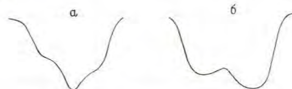
Р и с. 5. Схема тонкой структуры линии в эффекте Звершеда: а - \theta = 45^\circ ; б - \theta = 70^\circ
